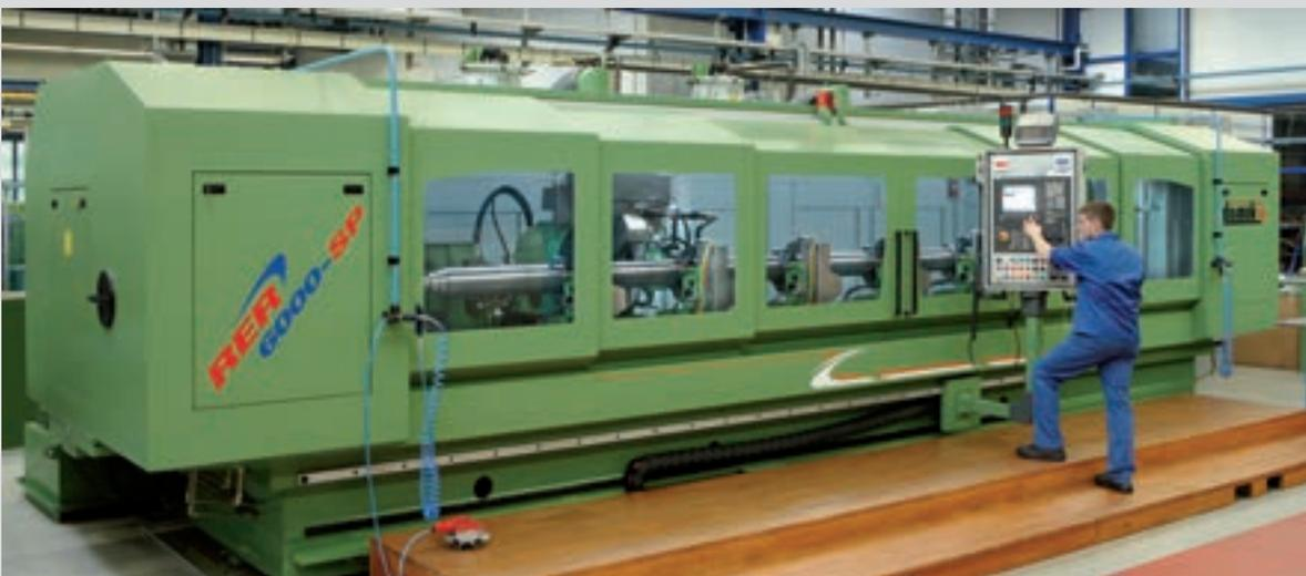
Innovative Fertigungstechnologie sorgt für höchste Präzision. So können bei der Firma Kammerer auf der Außengewindeschleifmaschine und der Wirbelmaschine Spindeln bis 6 m Gewindelänge in einer Aufspannung und einem Durchmesser bis 160 mm gefertigt werden.
